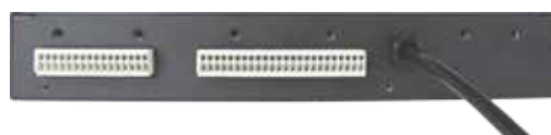
Achterkant van de Mi-8000 terminal met acht sensoren, acht relais en stroomkabel
