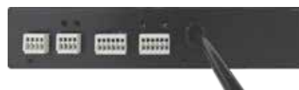
Achterkant van de Mi-4000 terminal met vier sensoren, vier relais en stroomkabel
